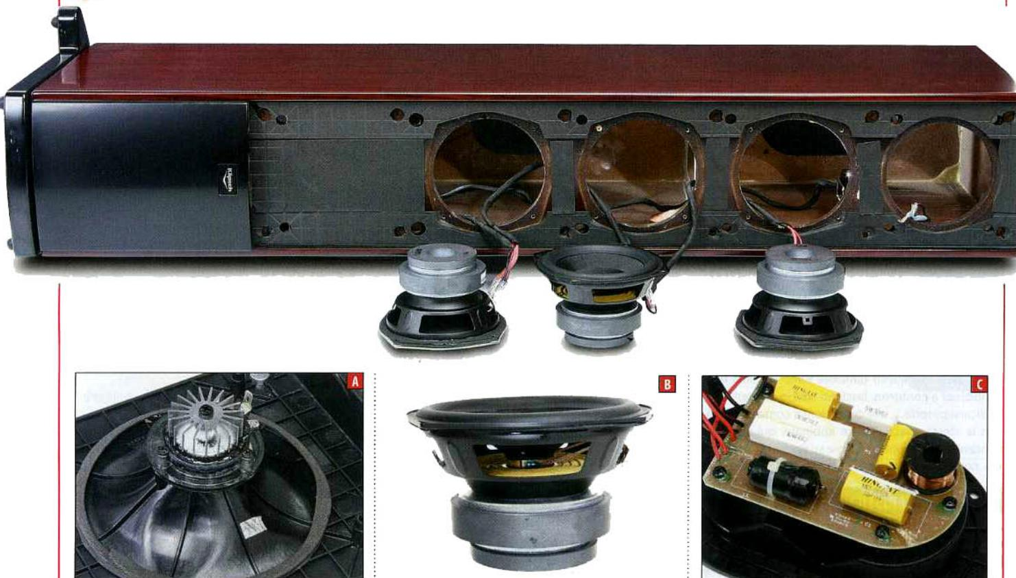
I WF 35 sono un sistema a torre a due vie in bass reflex con quattro altoparlanti. Il mobile e la realizzazione in generale denotano la classe economica del prodotto, ma l'impostazione, le soluzioni e alcuni dei risultati di laboratorio evidenziano invece l'ottimo lavoro di progettazione principalmente orientato all'ottimizzazione delle condizioni di utilizzo in ambiente.
